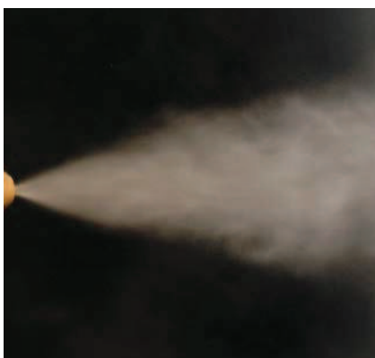
Tipo / Type AAI Getto atomizzato a cono pieno. Atomized jet full cone-shaped.
